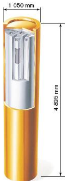
Rys. 7. Zbiornik miedziany z wypalonym paliwem jądrowym.
